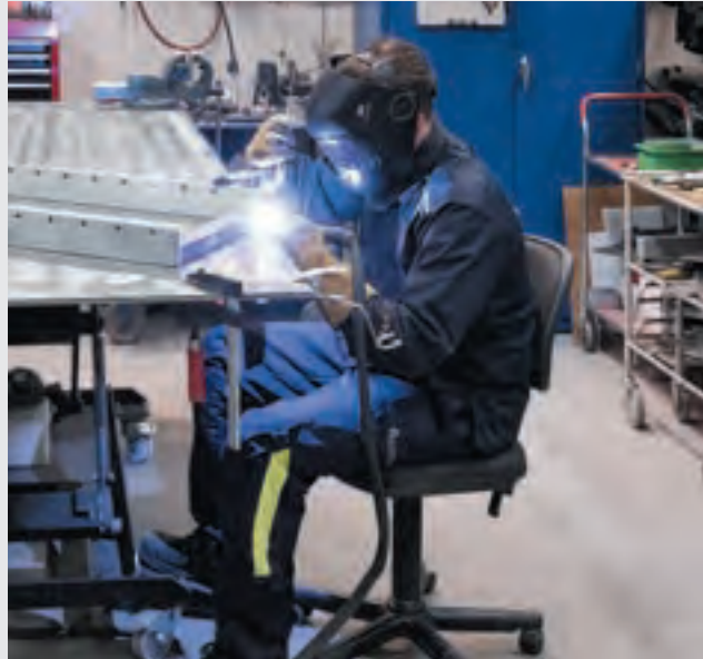
Hochpräzise WIG-Schweißarbeiten, bei denen eine weite und „klare“ Sicht erforderlich ist.
